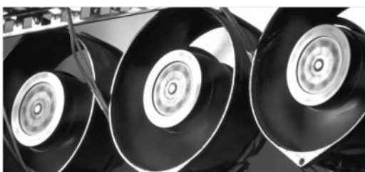
Ventiladores na cabine de teste de resistência em St. Georgen. 1.500 ventiladores estão em funcionamento e são monitorados em cabines de temperatura controladas até que haja alguma falha
