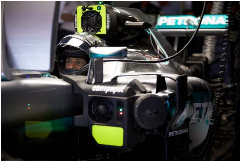
Fig. 1: Um sistema de refrigeração, idealizado pela ebm-papst transmite o calor preso para fora das aberturas side-pods e roll-hoop .
