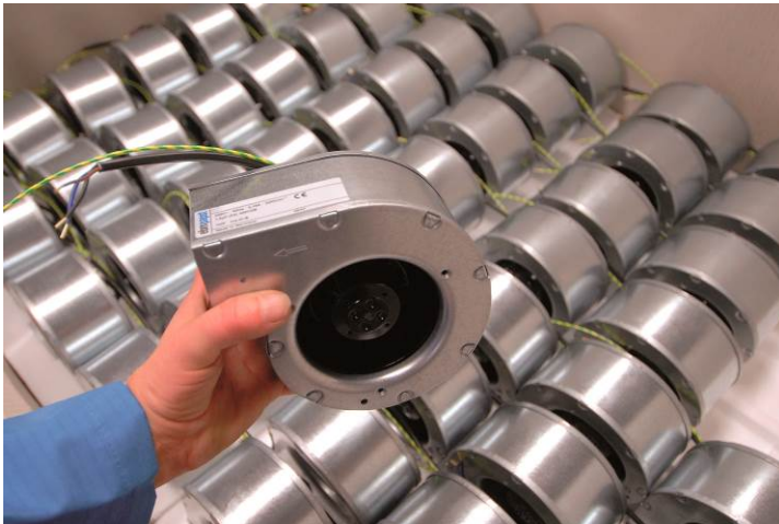
Fig. 3: O ventilador centrífugo da ebm-papst fornece ar refrigerado para o pit wall.
